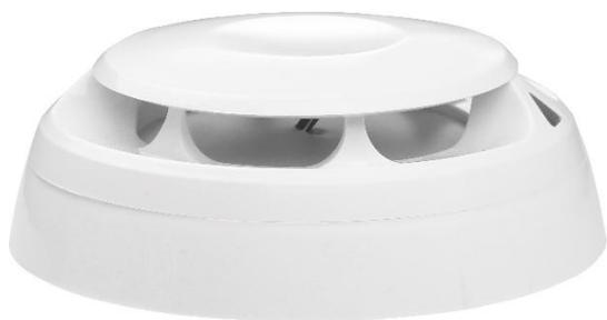
دکتور حرارتی مدل S6-CRD-200 با اندازه‌گیری دما و نرخ رشد آن، به افزایش ناگهانی دمای محیط و همچنین به بالا رفتن دما از یک مقدار مشخص واکنش نشان داده و اعلام حریق می‌نماید. عملکرد دکتور بر اساس استانداردهای مربوطه تنظیم شده است به گونه‌ای که با افزایش دما با نرخ رشد ۸ درجه سانتی‌گراد بر دقیقه فعال می‌شود. این دکتور برای مکان‌هایی که در آن‌ها مواد دودزا در محیط وجود دارد و همچنین محیط‌هایی که در صورت بروز آتش‌سوزی، حریق به سرعت رشد می‌کند، مناسب می‌باشد.
