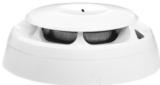
دتكتور مولتى مدل S6-CMD-200 يك محصول مولتى سنسور است که در واقع تركيب دتكتور دودي و حراري- دما ثابت می باشد. اين المان با استفاده از پديده شکست نور، دود موجود در محبيط و توسط سنسور حراري، دمای محبيط را سنجش می کند و در صورت وقوع آتش سوزی اعلان حريق می فايد.
