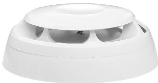
دتکتور آدرس پذیر حرارتی دما-افزایشی مدل S6-ARD-300 با قابلیت اندازه گیری دما و نرخ رشد آن، علاوه بر دمای محیط به نرخ افزایش آن نیز واکنش نشان داده و اعلام حریق می نماید. طراحی دتکتور بر اساس استانداردهای اروپا صورت گرفته است به گونه ای که با افزایش دما با نرخ رشد ۸ درجه سانتی گراد بر دقیقه فعال می شود. این دتکتور برای مکان هایی که در آنها مواد دودزا در محیط وجود داشته باشد و همچنین برای محیط هایی که در صورت بروز آتش سوزی حریق به سرعت رشد می کند، مناسب می باشد.
