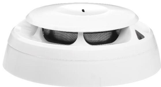
دتكتور S6-AMD-300 از نوع دتكتور مولتى سنسور آدرس-پذير است که در واقع ترکيب دتكتور دودي و حرارتى دما-ثابت می باشد. اين دتكتور با استفاده از پدیده شکست نور، وجود دود در محيط را تشخيص می دهد و با استفاده از سنسور حرارتى دمای محيط را اندازه گيري کرده و با عبور از مقدار تعیین شده، اعلام حريق می نماید. از اين رو اين دتكتور می تواند به منظور استفاده در محيظهاي مختلف گزينه مناسب باشد چرا که بطور همزمان دو فاكتور ناشی از حريق را بررسی می نماید.
