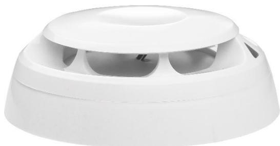
دتکتور حرارتی دما-ثابت آدرس‌پذیر مدل S6-AHD-300 با استفاده از سنسور حساس به دما در صورتیکه دمای محیط بیشتر از ۶۲ درجه سانتی‌گراد شود اعلان حریق را به مرکز کنترل گزارش می‌نماید. این دتکتور برای مکان‌هایی که در آن‌ها مواد دودزا در شرایط عادی وجود دارد، مناسب می‌باشد.
