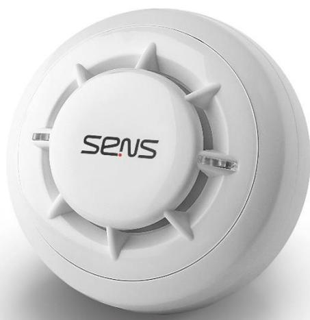
دتکتور حرارتی مدل S2-CRD-200 با اندازه‌گیری دما و نرخ رشد آن، به افزایش ناگهانی دمای محیط و همچنین به بالارفتن دما از یک مقدار مشخص واکنش نشان داده و اعلام حریق می‌نماید. عملکرد دتکتور بر اساس استانداردهای مربوطه تنظیم شده است به گونه‌ای که با افزایش دما با نرخ رشد ۸ درجه سانتی‌گراد بر دقیقه فعال می‌شود. این دتکتور برای مکان‌هایی که در آن‌ها مواد دودزا در محیط وجود دارد و همچنین محیط‌هایی که در صورت بروز آتش‌سوزی، حریق به سرعت رشد می‌کند، مناسب می‌باشد.
